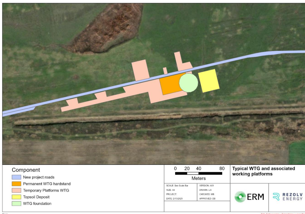
FIGURA 2-2 WTG TIPIC ȘI PLATFORME DE LUCRU ASOCIATE
