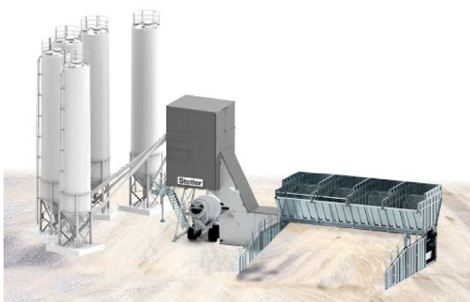
Proiect stație betoane
