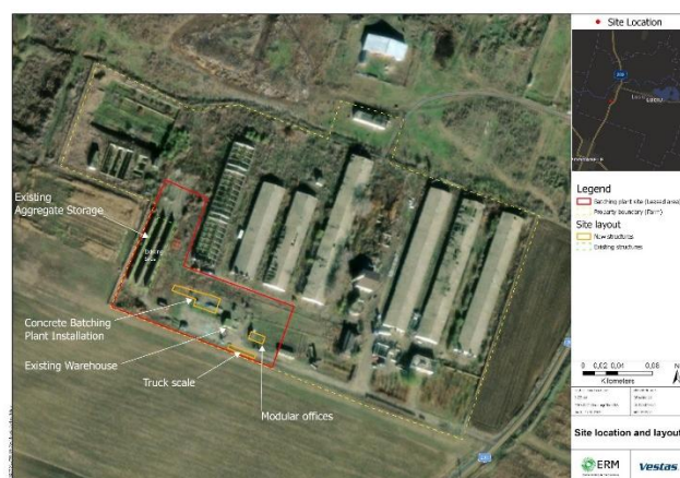
Locație stație betoane
